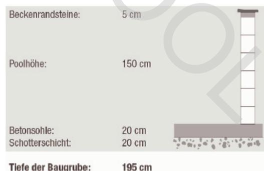
Weiters ist die Baugrube um ca. 1 m größer als das Beckenaußenmaß auszuheben, damit die Verrohrung leicht montiert werden kann. Um spätere Erdarbeiten zu vermeiden, können Sie bereits jetzt eine eventuell später anzuschaffende Solaranlage berücksichtigen. Sie brauchen dafür nur die benötigten Rohrleitungen schon jetzt zu verlegen.
